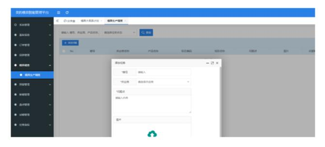
EMITTIMS模具智能计数器是广东新睿仕德智能系统有限公司开发的模具智能化数据采集器,属于无源设备互联智能化数据采集器。产品自带无线定位模块、计数模块和数据传输模块。主要功能是自动为模具提供位置信息、数量信息和成型周期等信息,利用以上信息通过软件系统大量逻辑运算为模具全流程监控和运营提供智能化管理。运营管理平台主要解决大量模具在注塑和冲压生产过程中运营管理难的痛点问题,应用场景:主机企业(美的、华为等)有大量模具外发多家供应商生产[MITT模具生产运营智能管理系统化解决方案,通过模具智能RFID数据采集器[4G[5G智能采集器配合智能化管理系统对模具进行全生命周期管理,解决企业大量模具外协供应商生产难以运营管理的痛点问题。计数架构:每套模具安装智能数据采集器一个(内置定位、计数、通讯模块)自动采集数据;系统通过4G[5G通讯基站定位及传输数据,云端服务器数据运算;云端服务器运行智能化管理系统,通过系统完成数据智能化运算,展示在企业PC端、移动端和电子看板:通过模具智能数据采集
